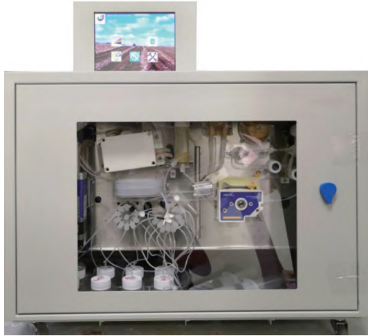
图 2 微流池多光程土壤有效态氮磷分析仪
